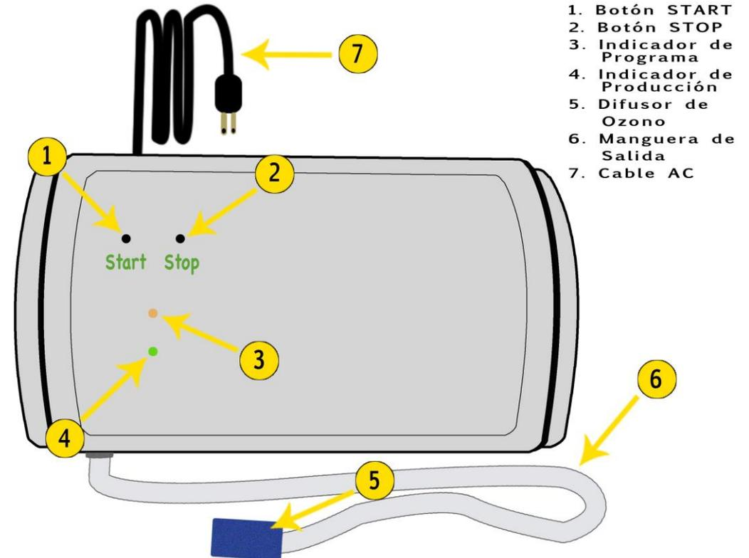
4. El **Indicador de Producción (4)** se encenderá, y la luz amarilla del **Indicador de Programa (3)** comenzará a parpadear, indicando el programa seleccionado, con un parpadeo cada dos segundos. Por ejemplo: para el *Programa 1* parpadeará una vez cada dos segundos, para el *Programa 2* parpadeará dos veces cada 2 segundos y así sucesivamente.
